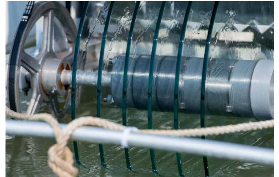
Ein ausgeklügeltes System: Die rotierenden Scheiben am Katamaran fangen den Oberflächenfilm ein.
